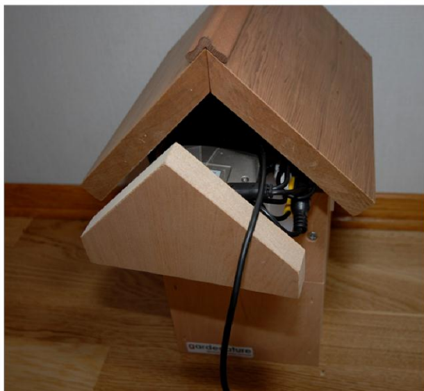
Tre forsiktig alt inn i kassen. Husk på å få alle koplinger inne i kassen slik at de ikke er utsatt for vann. Ledningen som her kommer ut av kassen må tres ved siden av fronten her i en glippe på høyre siden av kassen (se neste bilde).
