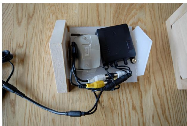
Den trådløse senderen kan legges inne i kassen sammen med kameraet.
