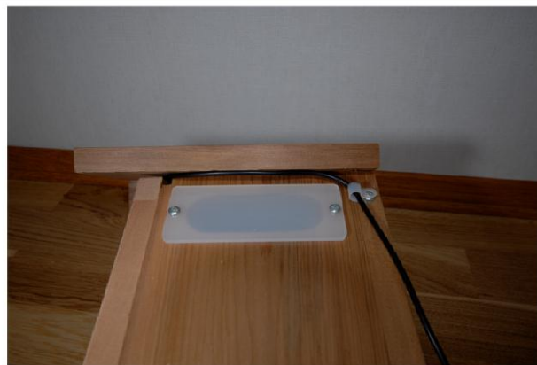
Her ser du hvordan ledningen kommer ut av hullet i kassen. Den kan også festes i plastløyken bak på kassen for å komme nærmere festet bak på kassen.
